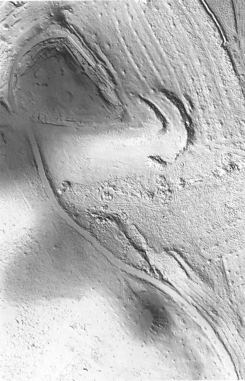
Εικ. 6. Ορθομοσaiϊκό και ψηφιακό μοντέλο εδάφους υψηλής ανάλυσης της ευρύτερης περιοχής του λόφου της Αγίας Κυριακής με τεχνικές τρισδιάστατης σάρωσης με λέιζερ τύπου LiDAR.
